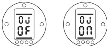
*Interrupter Timer Disabled*      *Interrupter Timer Enabled*
