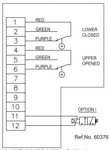
D413-V3LD 30V DC / 125V AC 100mA V15H16-CZ200-A02/V15H16-CZ100-A02 250V AC 6A, DC 0,25A, 125V DC 0,5A, 24V DC 5A
