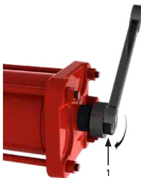
5. 揺動角を下げる場合は、ストップボルト(1)を時計方向に回して下さい。
