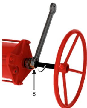
J. 搖動角を下げる場合は、ストップボルト(8)を時計方向に回して下さい。
