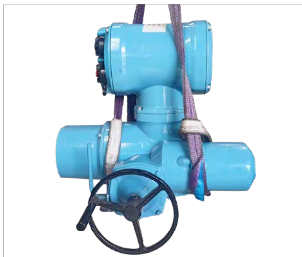
CKQ Atronik执行机构使用吊索吊装
