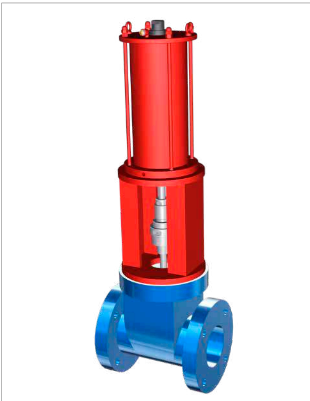
Fig 10.2 Exemplo de montagem de atuador/válvula
