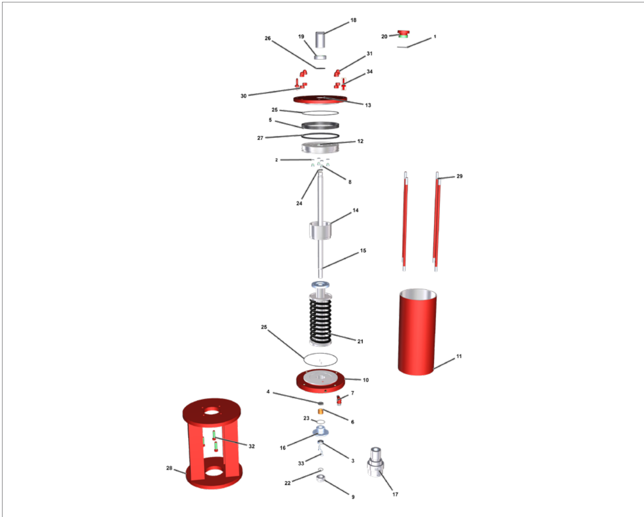
Fig 17.2 Actuador neumático lineal tipo 0 con muelle hacia arriba
