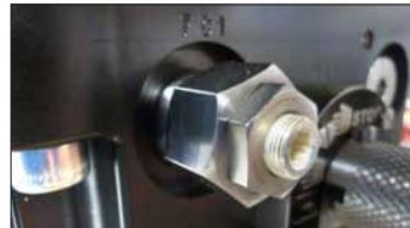
压力补偿阀 – 逆时针旋转减速, 顺时针旋转加速。
