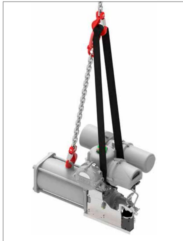
图 4.1.2 SI3 RH 吊装: 吊索连接到吊眼和控制单元箱体。
