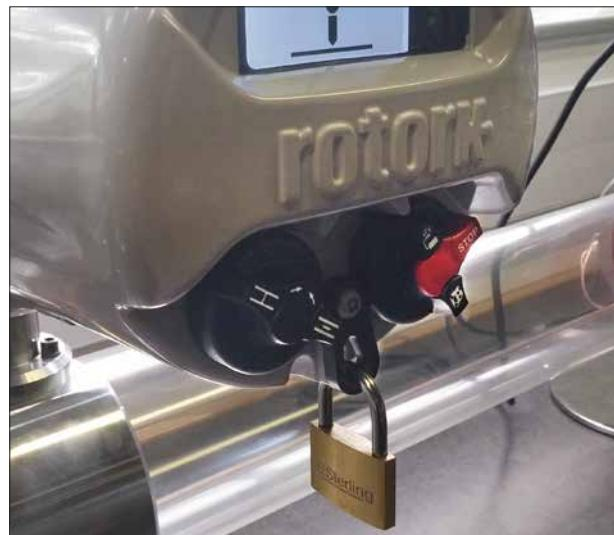
图 7.2. IQ 控制旋钮锁定在 "远程" 位置
