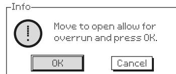
将执行器和阀门动作至全开位置。手轮打死后，可向开方向回  $\frac{1}{2}$  至 1 圈。
