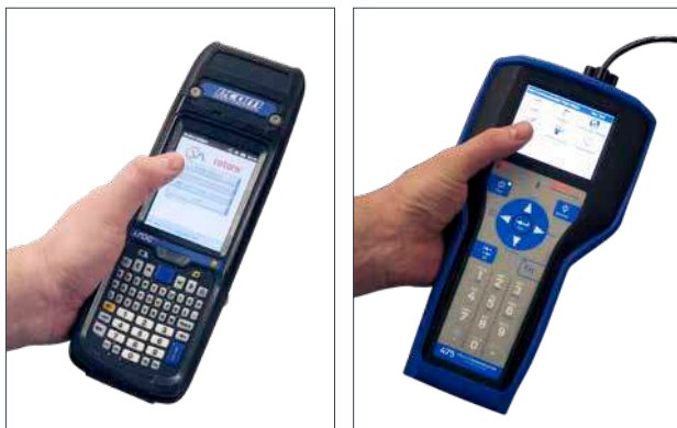
図1 ECOM（左）とRosemount475（右） CVAの設定は、PCや汎用HARTコミュニケーター（例：ECOM、Rosemount475）などのBluetooth無線機器を使用しています。
