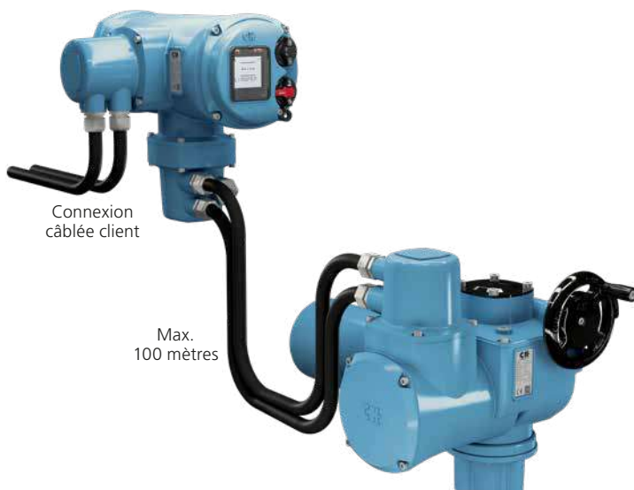
Commandes Centronik montées à distance, jusqu'à 100 m de la motorisation
