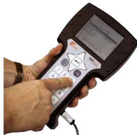
Figure 1. La motorisation CVA peut être configurée grâce à un appareil équipé de la technologie sans fil Bluetooth tel qu'un PDA ou un PC, ou via un communicateur HART.
