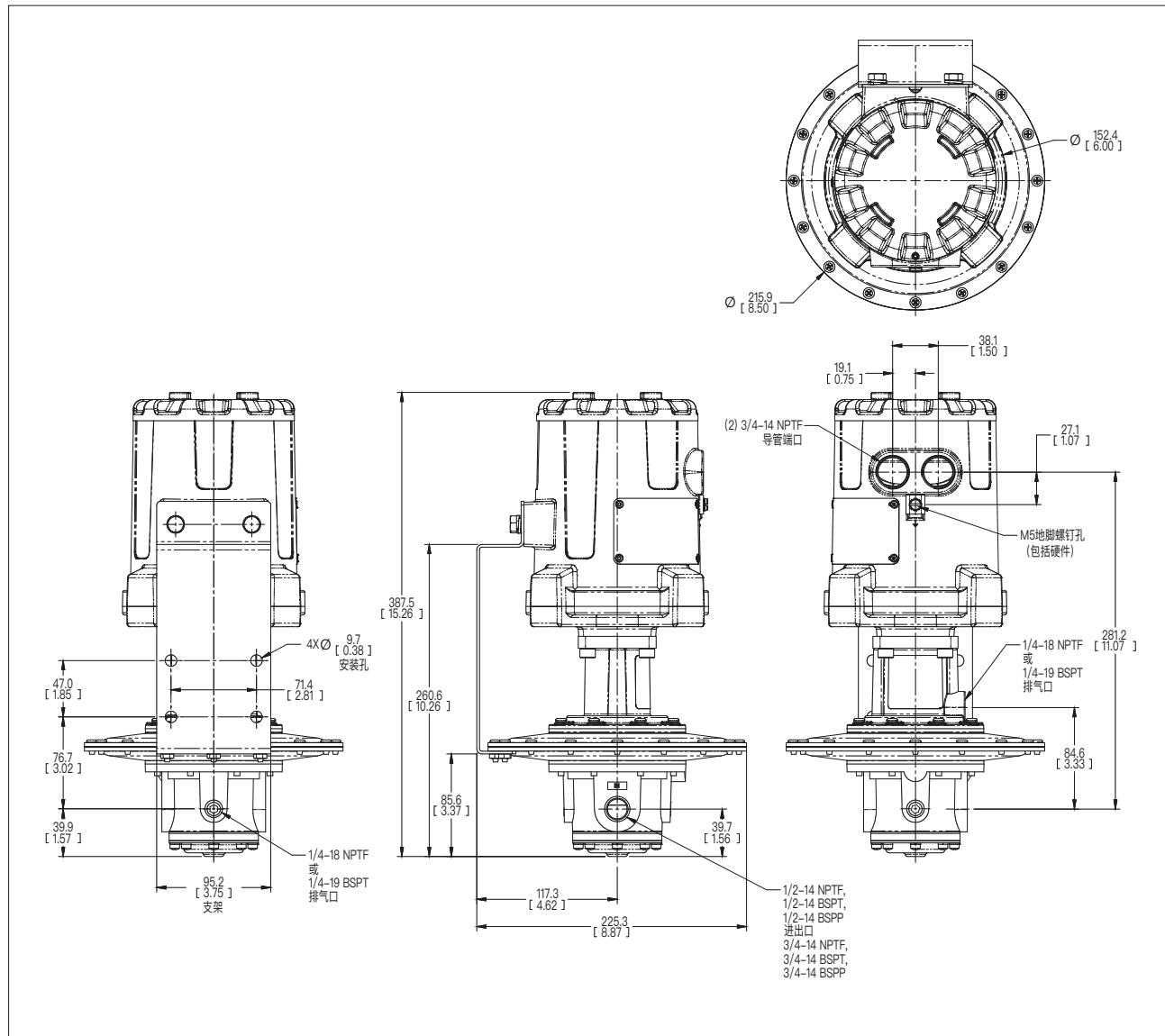
图 15 PAX1和4100A型压力调节器
