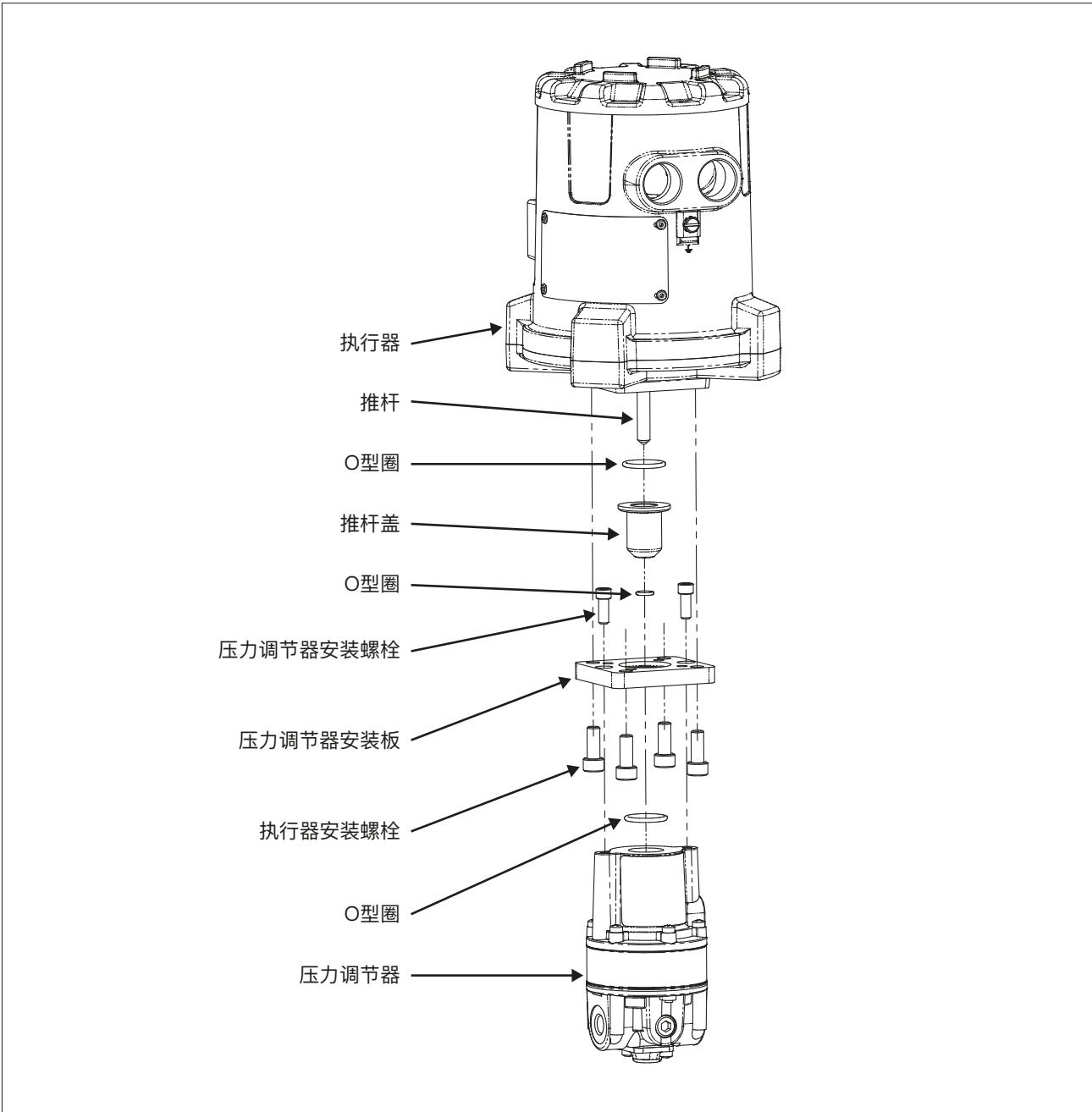
图 20 PAX1执行器和压力调节器总成
