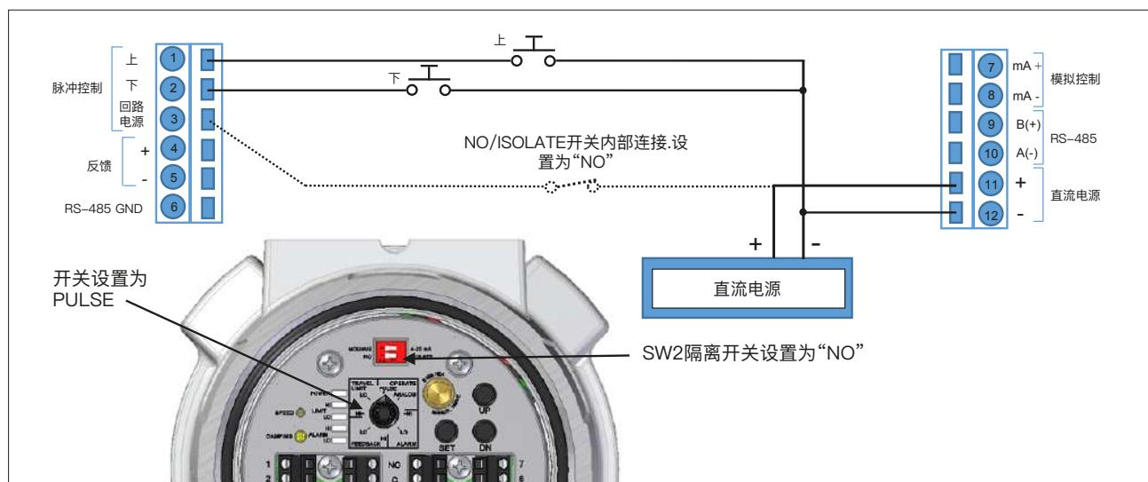
图 4 使用脉冲控制回路电源的通用电源进行非隔离脉冲输入控制
