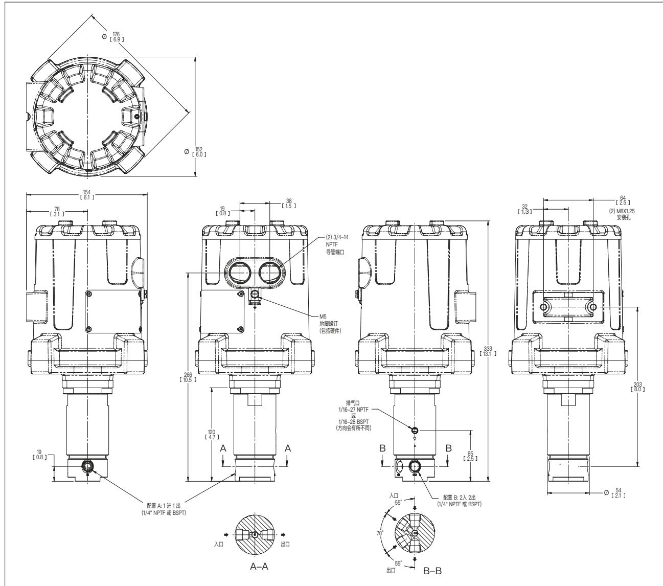
图 16 PAX1和HPD或HPP型压力调节器
