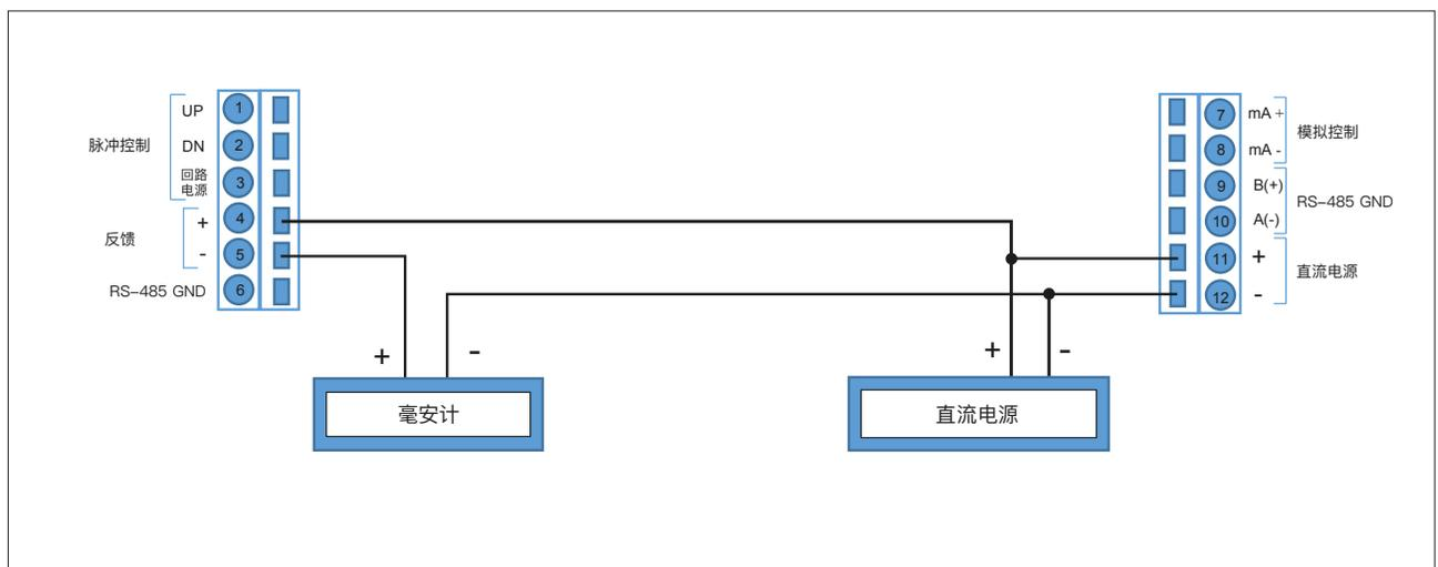
图 7 使用反馈回路电源的非隔离反馈
